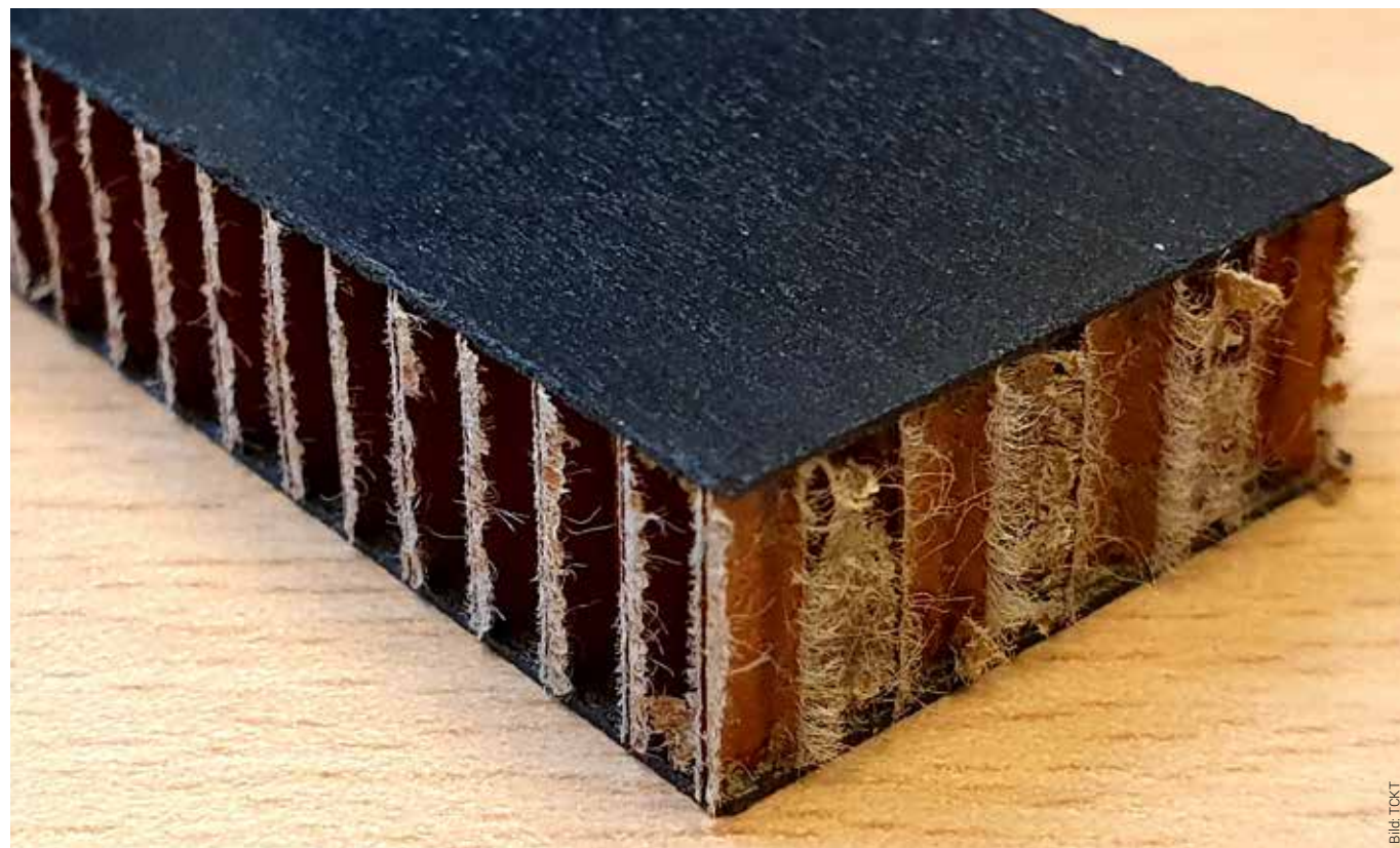
Das TCKT hat ein innovatives Verbundmaterial aus rCF-Vlies auf einem Wabenkern entwickelt.
