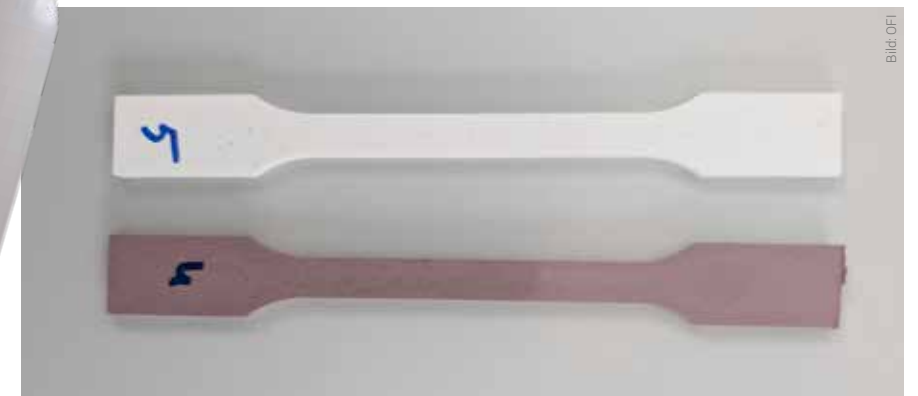
Spritzgussprüfstab aus metallisiertem, bedrucktem, recyclingfähigem PP-Monomaterialverbund (oben) sowie Spritzgussprüfstab aus den Ausgangsfolien ohne Metallisierung und Bedruckung (unten)
