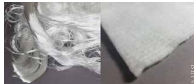
PLA-Fasern (links) und PLA-Vlies (rechts) aus 100 % recykliertem PLA
