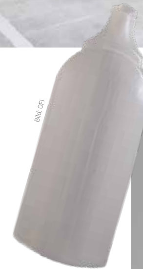
Flasche aus einer PP/EVOH/PP-Folie aus 100 Prozent Rezyklat
