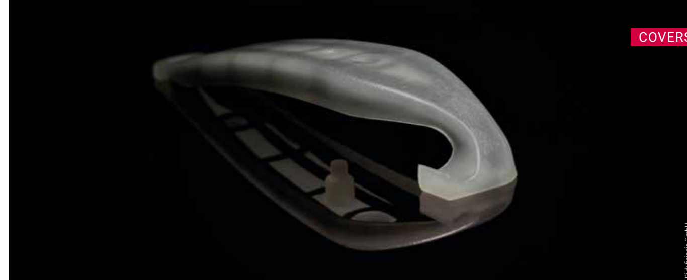
Fahrradreifenheber: Das optimierte fibonic Carbon-Skelett wird im Spritzguss integriert, wodurch sich neue Anwendungsmöglichkeiten für Kunststoffe eröffnen.
